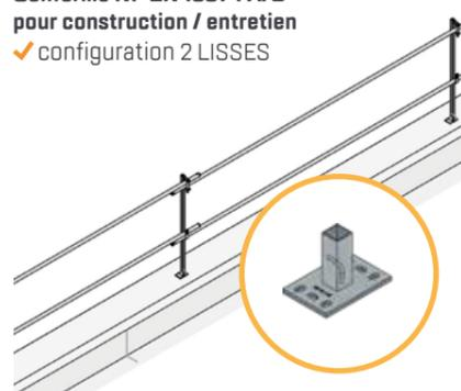
L'utilisation de ce type de garde-corps dans la sécurisation de travaux d'étanchéité en France, nécessite que la toiture soit plate ou l'inclinaison de la pente <10° (NF P 93-355).
