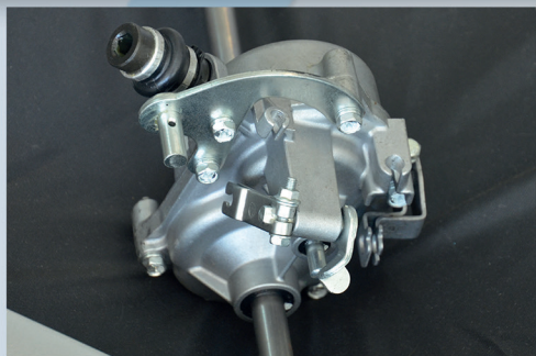
Boîte de vitesses mécanique 2 vitesses entraînée par cardan
