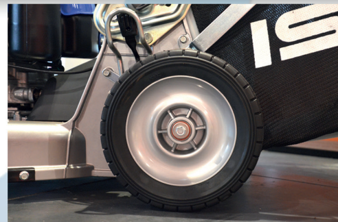
Conception professionnelle de haute résistance (2 roulements à billes étanche par roue)
