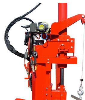
Option treuil électrique pour fendeuses à bûches de 13 à 31 tonnes. Puissance de tirage : 830 KG à 15 mètres / 1320 KG à 2 mètres. Câble acier Ø 5 mm - longueur 15 mètres. Commande électrique par bouton poussoir pour montée et descente du câble. Treuil débrayable pour le tirage manuel du câble. Alimentation direct sur batterie
