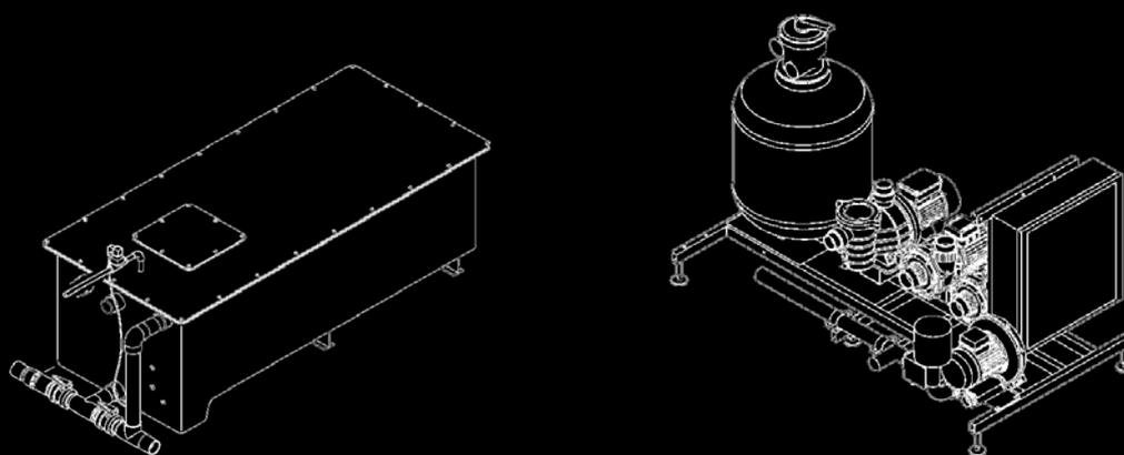
Élément distinctif de ces modèles, la grille de débordement qui entoure entièrement le spa présente une inclinaison de 15 degrés. L'eau qui « déborde » de la cuve en surface passe à travers cette grille jusqu'à un bac tampon. Une fois traitée par le système de filtration, l'eau est réinjectée dans le fond du spa au moyen d'une pompe. Grâce à l'inclinaison de la grille, le niveau d'eau du spa reste toujours le même, même en cas de tangage sur un yacht ou un navire de croisière.
